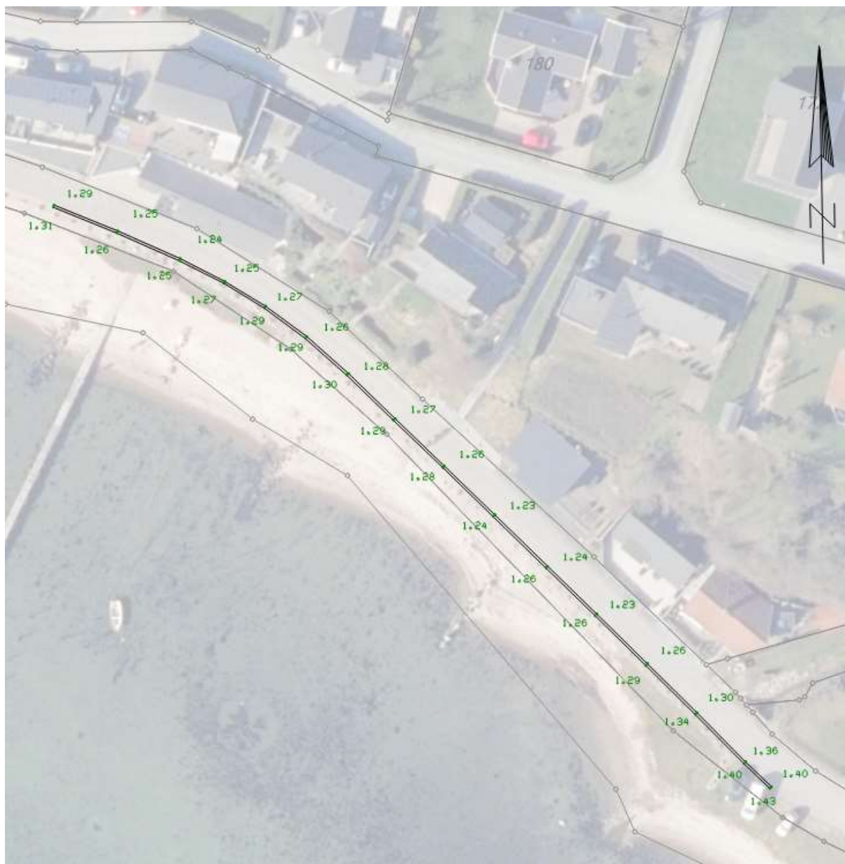
Figur 17 viser opmåling af kantstenen fra det lavest liggende område og ned mod lystbådehavnen. Opmåling udført af Skovgaard Landinspektørfirma.
