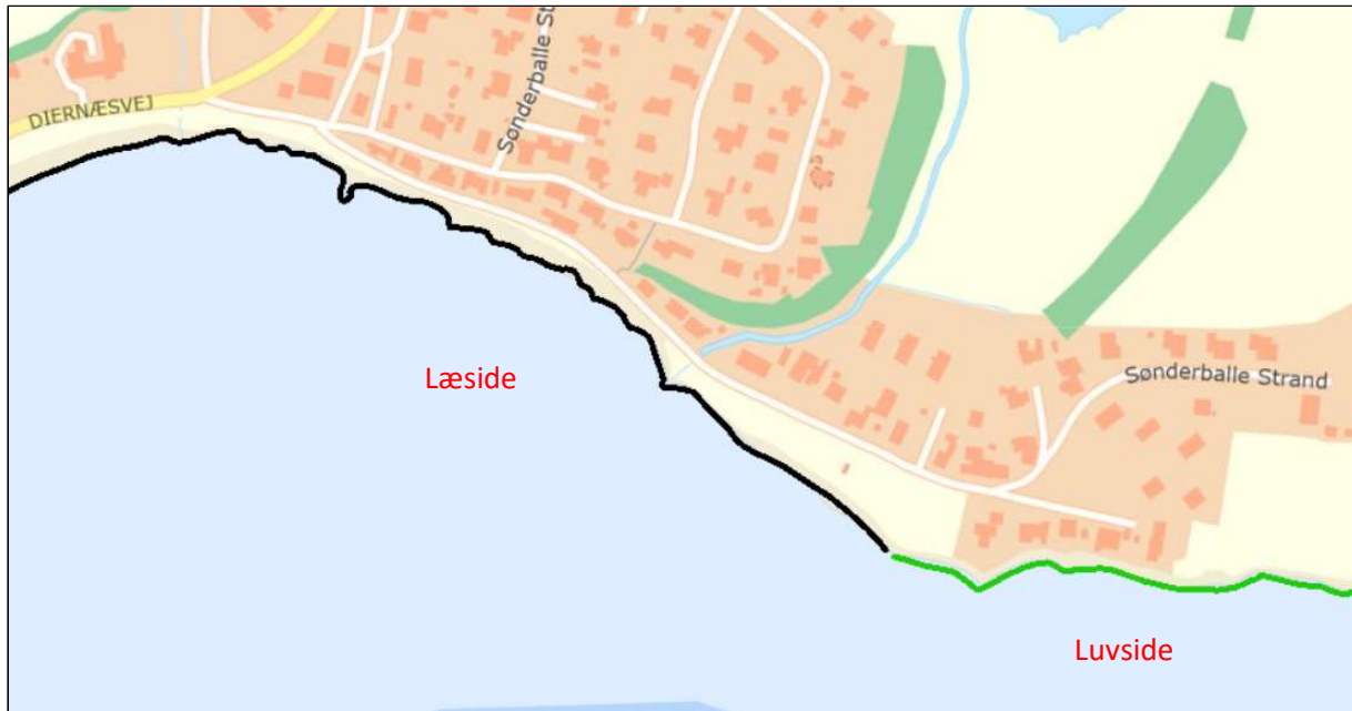
Figur 13 Kort der angiver zoner med mild tilbagevækst (sort streg) og fremrykning (grøn streg), fra Kystdirektoratets Kystatlas.
