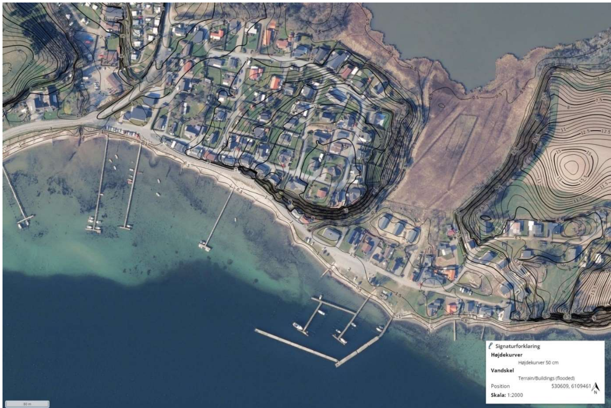
Figur 14 viser et koteniveau kort for Sønderballe Strand, med inddeling pr. 0,5 m. Kote efter DVR90. Fra Scalgo.
