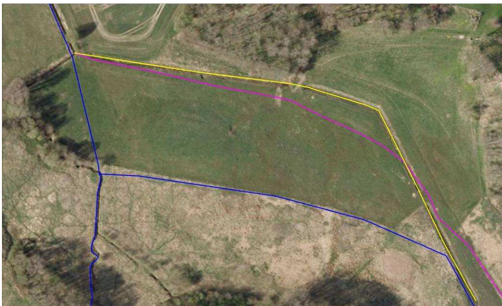
Figur 5: Sammenligning mellem regulativmæssig og eksisterende vandløbslinje. Den sydlige (blå) linje er den regulativmæssige, mens den nordlige (gule) linje er den åbne bæk. Den lille linje i midten viser den faktisk registreret GIS linje.
