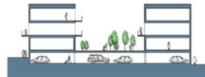
Principsnit, parkering delvis nedgravet mål 1:500
