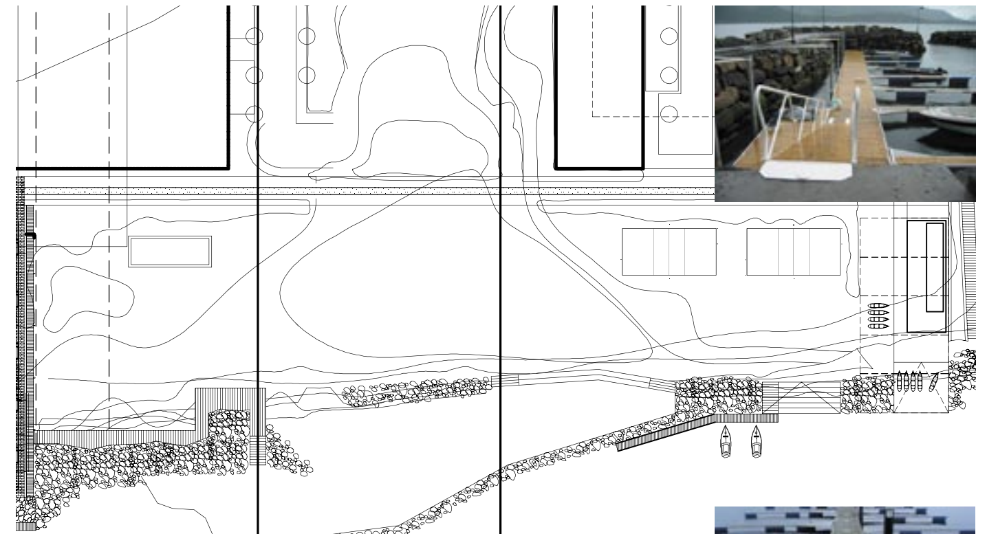
Principplan - optagning af niveauspring mod vandet ved etablering af stensætning, trappeanlæg og påfyldning samt neddrampning af strandbred 1:1000
