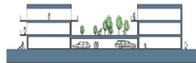
Principsnit, parkering mellem bygninger mål 1:500
